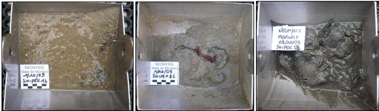
Figure 56 : Photos d'un sable légèrement vaseux vers une vase sableuse en fond de baie
