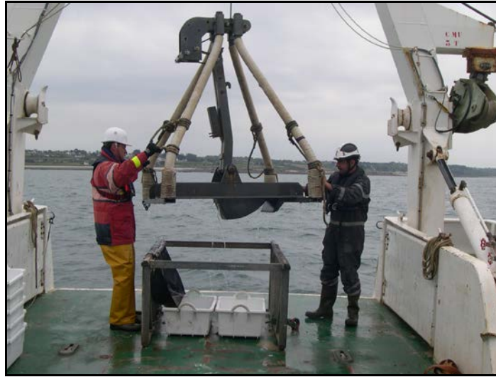
Figure 29 : Mise en œuvre de la benne Hamon
