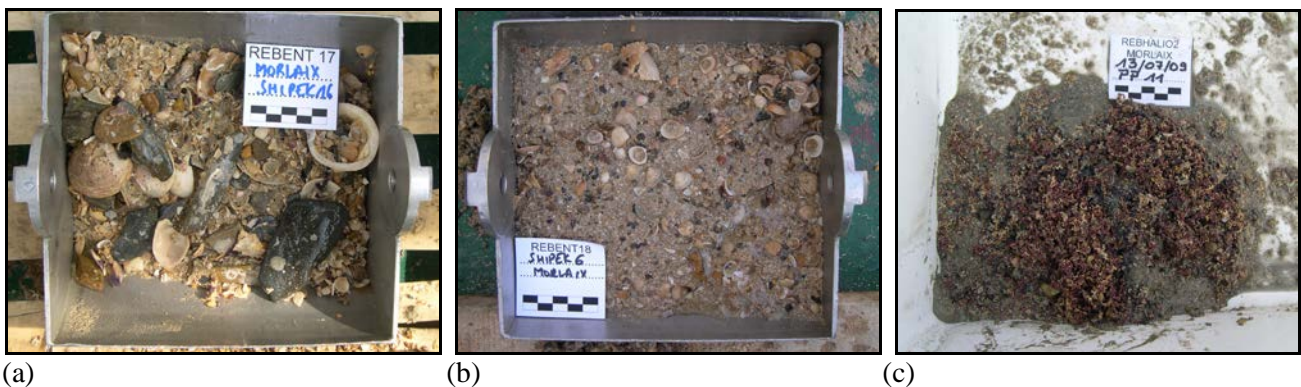
Figure 33 : Exemples de sédiments récoltés avec les bennes Shipek (a, b) et Petite Ponar (c)
