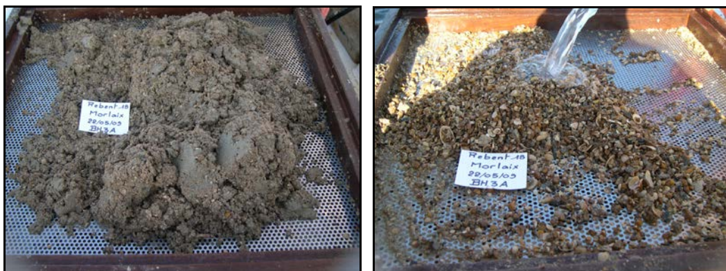
Figure 34 : Exemple de prélèvement à la benne Hamon (avant et après lavage sur table de tri)
