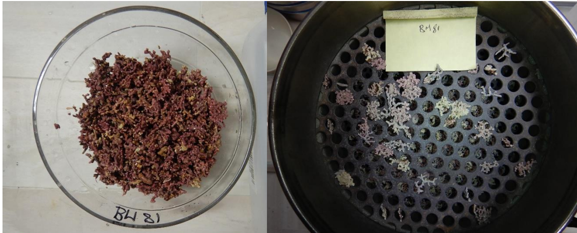
Figure 27. Echantillon brut (à gauche) et fraction grossière après tamisage (à droite)
