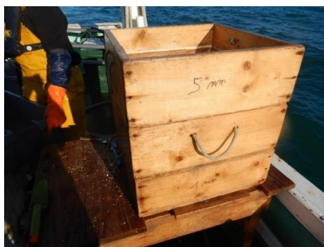
Figure 29. Colonne de tamis de 5mm, 2mm et 1mm
