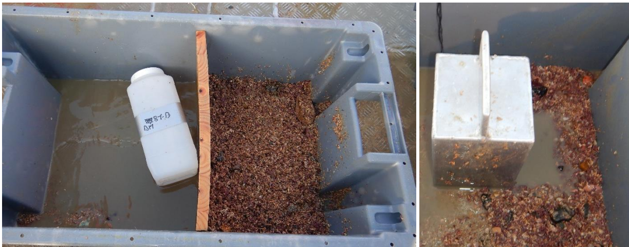
Figure 25. Répliquat de benne de 0,1m 2 repositionné de manière homogène sur une surface de 0.1 m 2 . Le carottier à main est ensuite utilisé pour prélever 1/64 m 2
